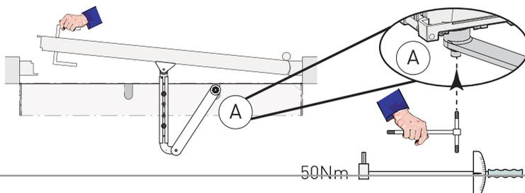
**NOTA:** abra ligeiramente a porta e aperte o parafuso da sede de suporte do braço [A] com uma força equivalente a 50 Nm (como indicado na figura). Se não dispõe de uma chave dinamométrica utilize uma chave sextavada do tipo indicado na figura, apertando forte e segurando a chave pelo lado longo.
