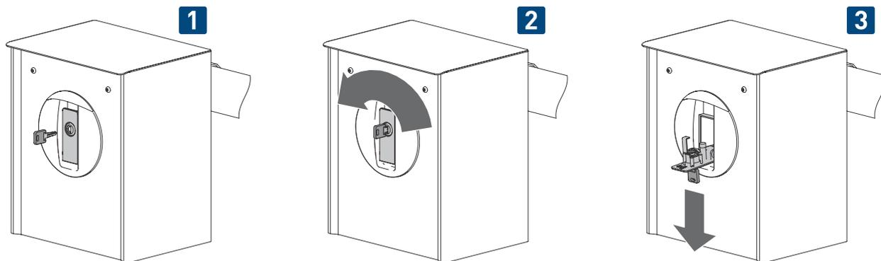
Em caso de avaria ou em ausência de tensão, inserir e girar a chave em sentido anti-horário, abrir completamente a portinhola. Abrir manualmente a barreira. Para bloquear novamente a barreira, fechar a portinhola, girar a chave em sentido horário e retirar a chave.
