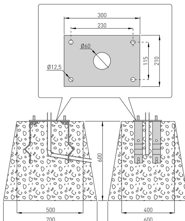
Se a pavimentação presente não consentir uma fixação robusta e estável da caixa, predispor uma plataforma de concreto onde introduzir os grampos de fixação e a chapa de base QIKZ, que deverá estar em nível e limpa.
