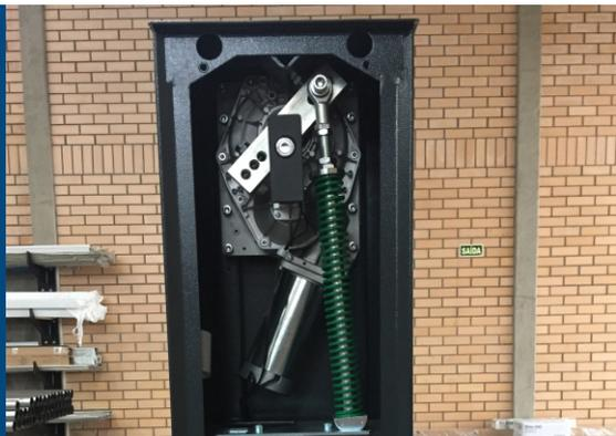
O QIKAM trata-se de um apoio móvel para a haste da cancela , é indicado para hastes a partir de 4,5 metros de comprimento. Com acabamento de alta qualidade e material resistente o QIKAM adapta-se nas mais diversas instalações.
